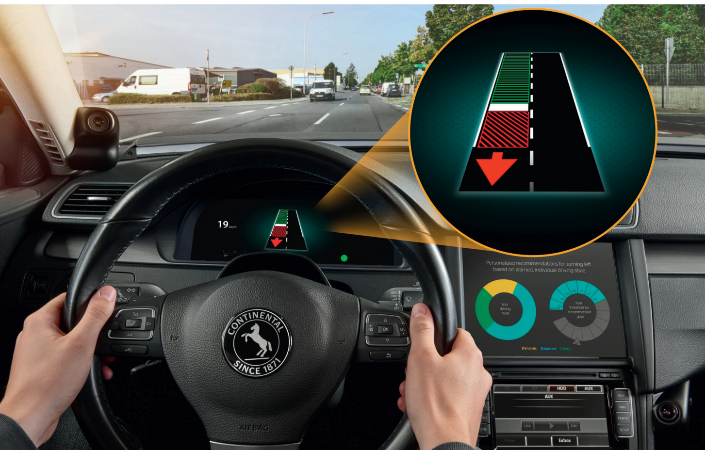
Das entwickelte und in einen Prototypen eingebaute System unterstützt Autofahrer in innerstädtischen Verkehrssituationen, hier beim Linksabbiegen. Eine Schlüsselrolle beim System spielt dabei maschinelles Lernen. © Continental
