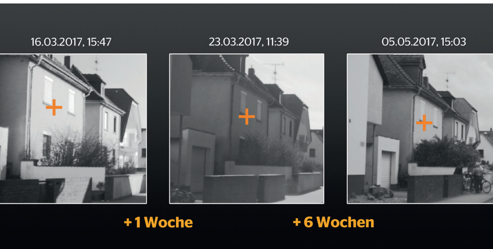
Bild 4: Wiedererkennung einer Landmarke über mehrere Wochen. Das Langzeit-SLAM-Verfahren erkennt auf häufiger befahrenen Strecken markante und beständige Landmarken und speichert diese in einer digitalen Karte ab. © Continental
